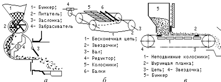
Рис. 2.50. Схемы механизации сжигания твердого топлива
